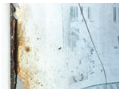
38. Plaadi servas tärglisrastrist irduv želatiinemulsioon, selle pinda hühtlaselt kattev "hõbepeegli"-kiht ja kriimustused emulsiooni pinnal. (5631/1691)
