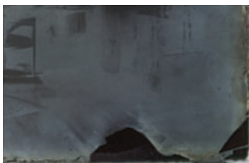
34. Tärklisrastri kihti paljastav zelatiinemulsiiooni deformeerumine võis juhtuda autokroomplaadi töötlemisel. Detail autokroomplaadist 5631/1691 (läbiv- ja pealtvalguses).
