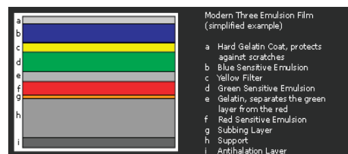
12. Kaasaegse kolme emulsioonikihiga värvifilmi läbilõike skeem
