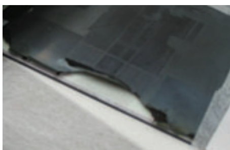
37. Klaaspõhimikult irduv emulsioonikiht (5631/1691)
