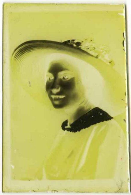
61. Negatiivi kollane toon viitab elavhõbejodiidi kasutamisele kõvendajas, EFA f 215
