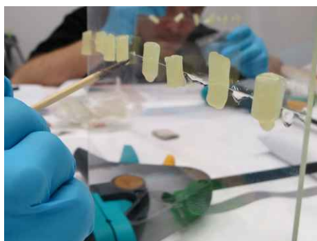
133./134. Katsed tavalise klaasiga kildude vertikaalseks liitmiseks, vahatükkide ja liimi abil
