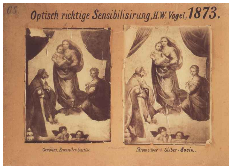
56. H. W. Vogeli katse klaasnegatiivi värvitundlikkuse parandamiseks, optilise sensibilisaatori eosini lisamise näol (tulemus parempoolsel pildil), 1873. a. Näitena Raffaeli maali „Sixtuse Madonna“ repro
