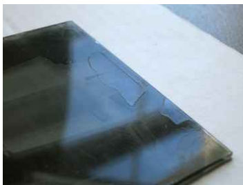
69. Reljeefsete servadega laigud, mis on lakist puutumata, viitavad laki pealekandmisele valamise teel, EFA f 215
