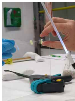
133./134. Katsed tavalise klaasiga kildude vertikaalseks liitmiseks, vahatükkide ja liimi abil
