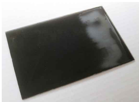
116. Soolade välja kristalliseerumise (hele piirkond) tagajärjeks on emulsioonikihi irdumine, EFA f 215
